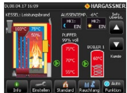
Kessel im Teillastbetrieb: Der Kessel läuft nur mehr mit halber Leistung. Der Boiler und der Puffer sind durchgeladen. Die Heizkreise liefern Wärme in die einzelnen Wohnbereiche.
