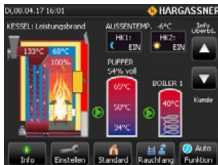
Kessel im Volllastbetrieb: Das Display zeigt Ihnen einen beheizten Kessel. Der Boiler und der Puffer werden bereits geladen und sind schon warm. Die Heizkreise liefern Wärme in die einzelnen Wohnbereiche.
